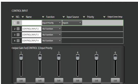
Input Source 输入来源选择：None, Input1-6, D-Input1-8。
