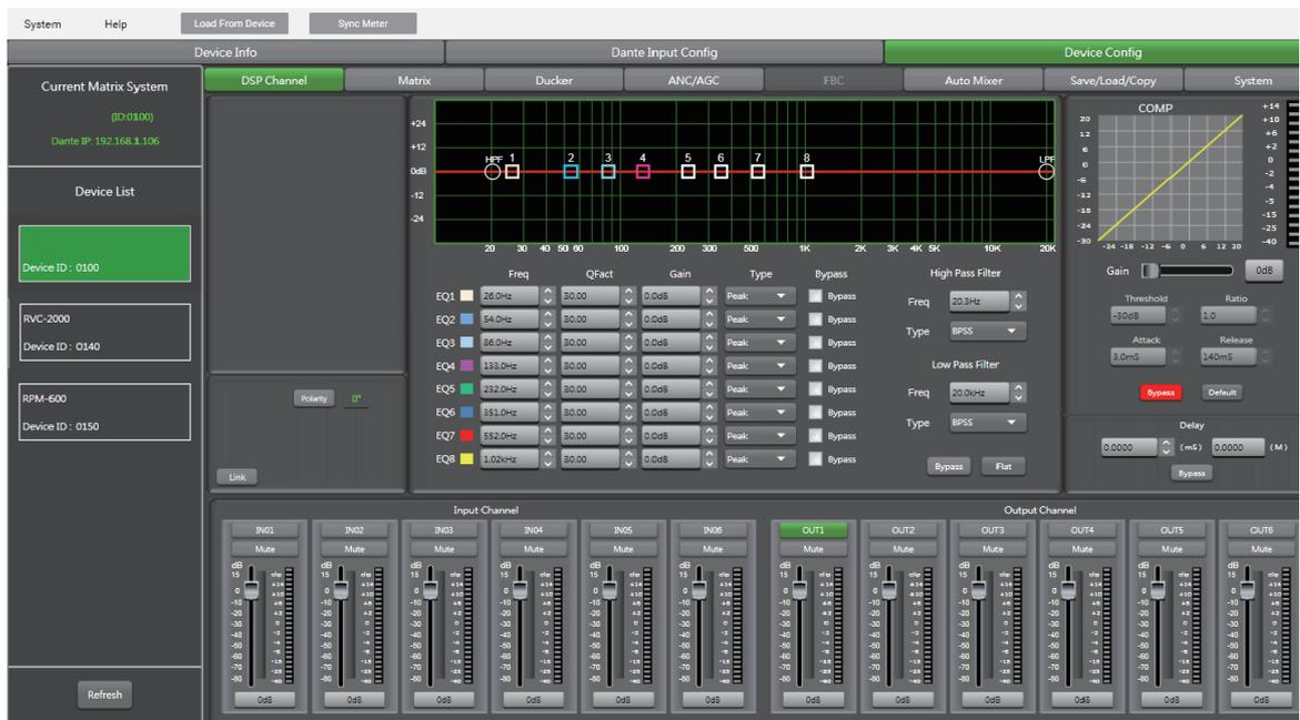
备注：与DSP输入通道的菜单基本相同，但没有“扩展器/门”部分。这里的参数EQ具有8个频段，详情可参阅DSP输入通道的介绍。
