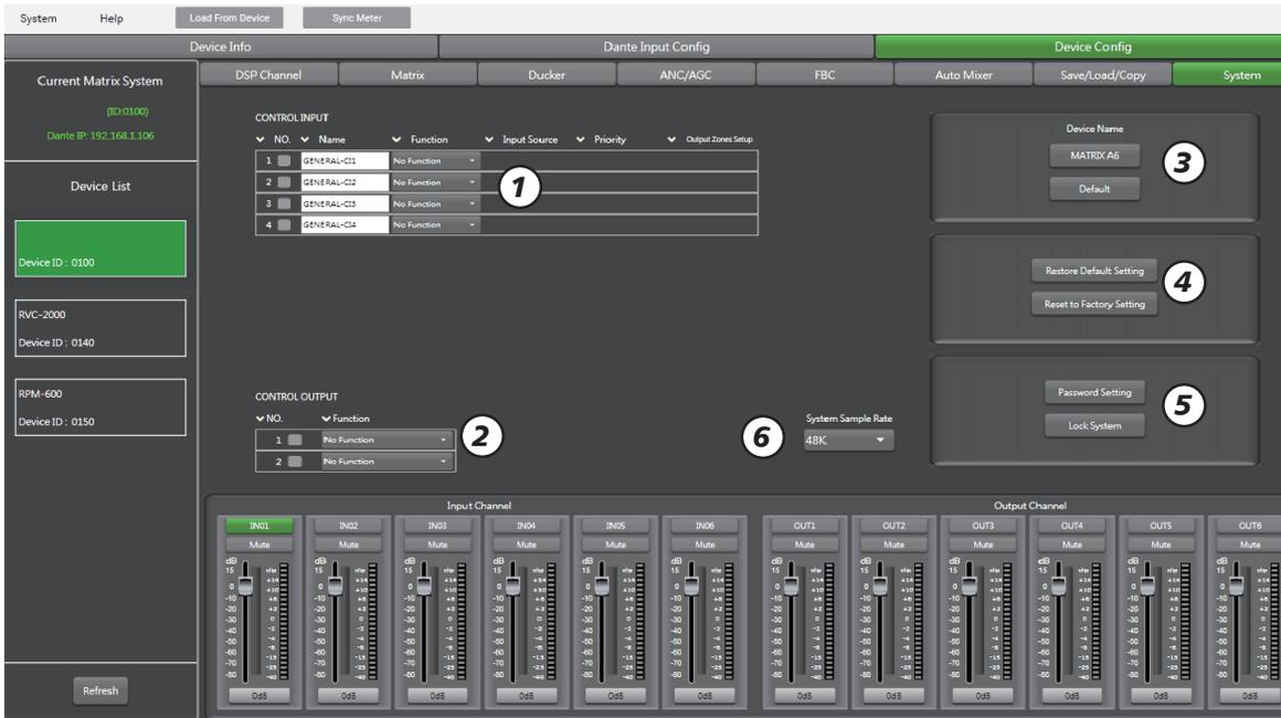
1) CONTROL INPUT：控制输入NO. 1-NO. 4，共计4个外部触发端口。
