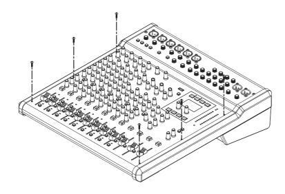
2. Use los tornillos de los accesorios para instalar el kit de montaje en rack del mezclador
